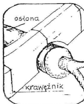
Rysunek: Zabezpieczenie korzeni przy układaniu krawężnika
