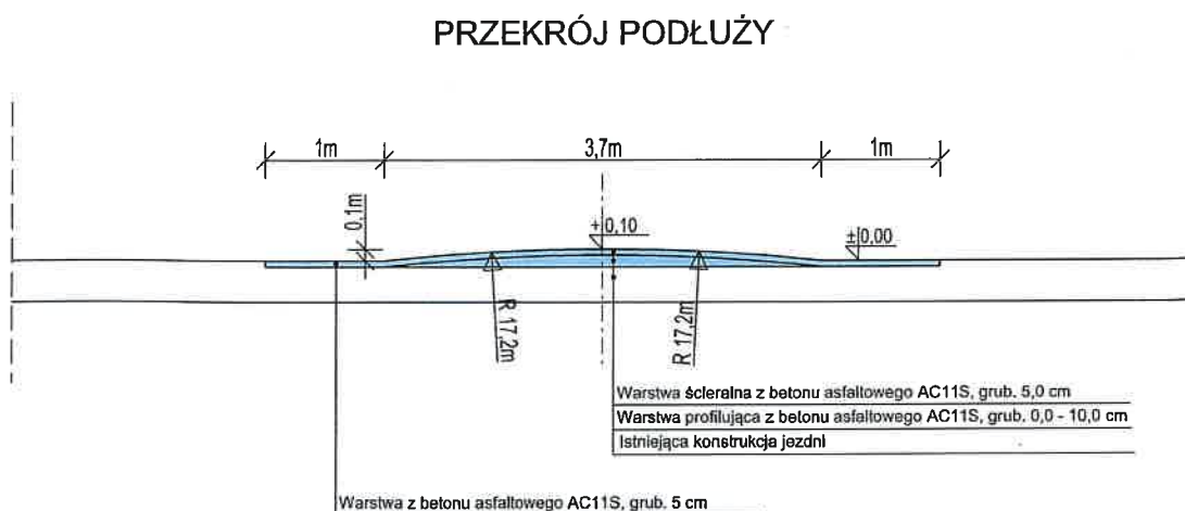
Rys. 1 Przekrój podłużny liniowego progu zwalniającego
