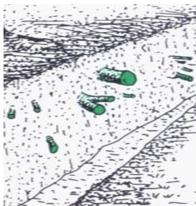
Ryc. 5. Postępowanie z korzeniami uszkodzonymi w wykopach. (rys. pochodzi z EuropeanTreeworker, wyd. EuropeanArbiculturalCouncil).
