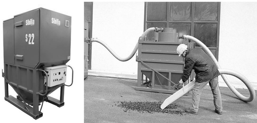
Fot. C i D. Przykład mobilnego odkurzacza przemysłowego typu Silba 22 [źródło: https://www.wirexim.pl/wynajem/ ]
