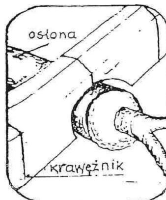
Rysunek: Zabezpieczenie korzeni przy układaniu krawężnika
