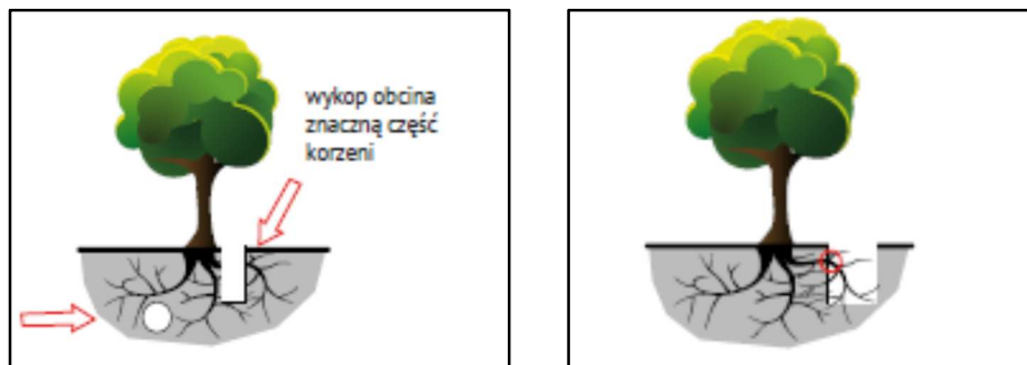
Rys. Rozwiązania niepoprawne – uszkodzenia systemów korzeniowych
