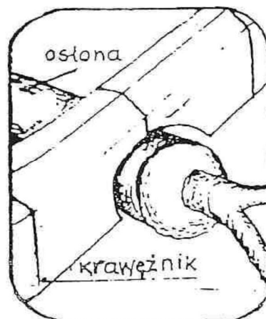
Rysunek: Zabezpieczenie korzeni przy układaniu krawężnika
