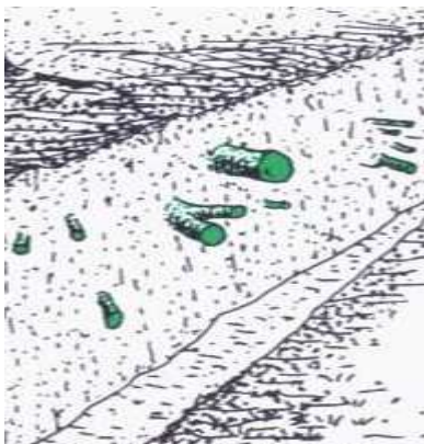
Rys. 4. Postępowanie z korzeniami uszkodzonymi w wykopach.
