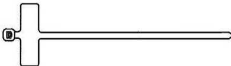
Rys.3: Etykieta do umieszczenia na taśmie oznacnikowej z tabliczką opisową. Wymiary: A- 25mm, B- 13mm
