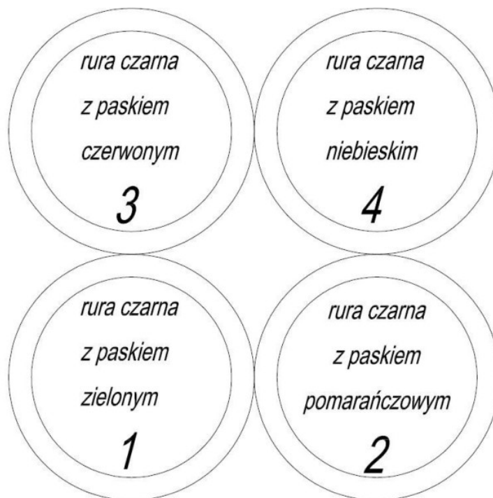
Rys.6 Układ rur w ciągu CRu
