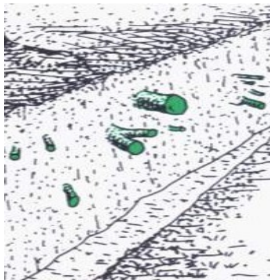
Ryc. 4. Postępowanie z korzeniami uszkodzonymi w wykopach.
