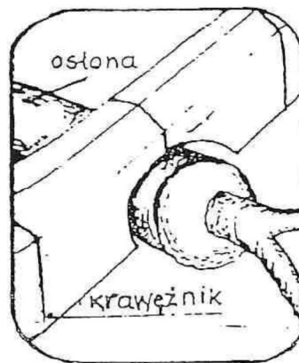
Rysunek: możliwe uszkodzenia spowodowane przez ruch pojazdów i maszyn budowlanych.
